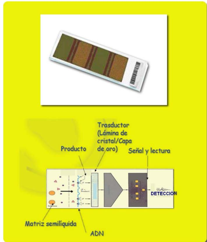
Figura 12: Detalles del Biosensor
