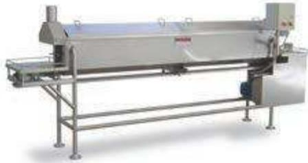
Fig. 4.14 Túnel de Agotamiento o Exhauster
