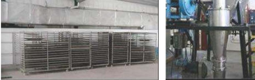
Fig. 4.11-2 Túnel de deshidratación Fig.4.11-3 Secador de aspersion
