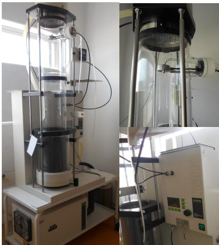
*Fig.1 Nanosecador por aspersión B-90.*
