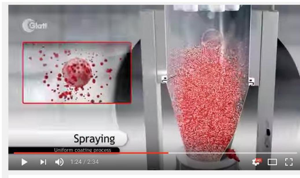
**Figura 9.** Lecho fluidizado para granulación por aspersión superior (Glatt®, 2017).
