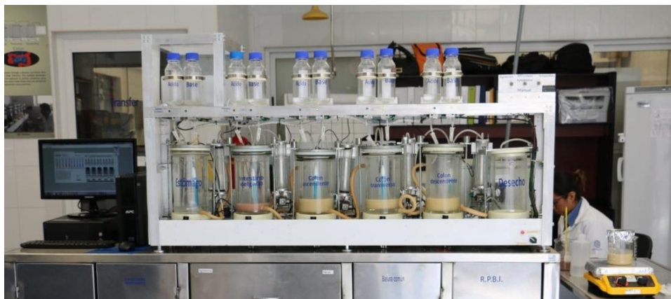
Fig. 2 Simulador del Tracto Digestivo Humano ARIS (Automatic and Robotic Intestinal System). Fotografía propiedad de Marisela González Avila
