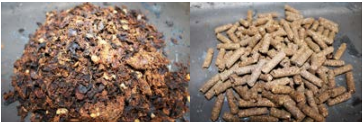
Figura 16: Pulpa pergamino elaborados como pellets listos para su combustión
