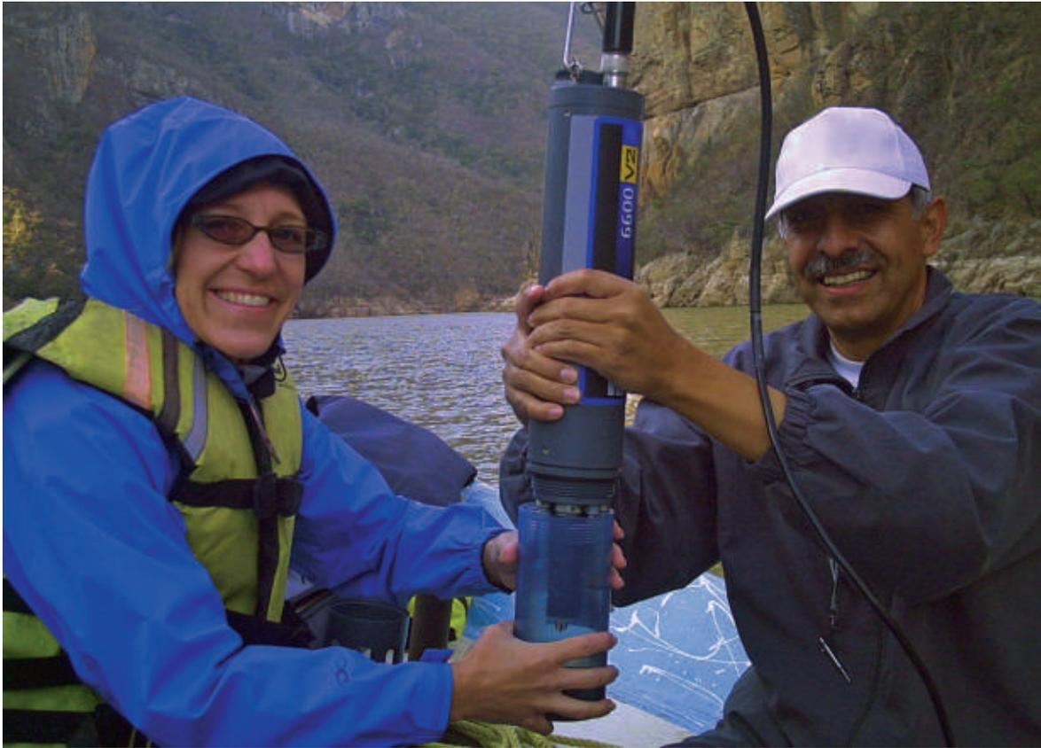
Preparación de la sonda multiparámetros para mediciones en campo.
