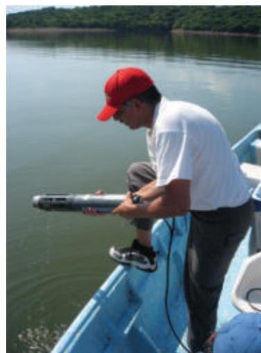
Preparación de sonda multiparamétrica para toma de lecturas de datos físicoquímicos y microbiológicos *in situ* en el embalse de Aguamilpa.
