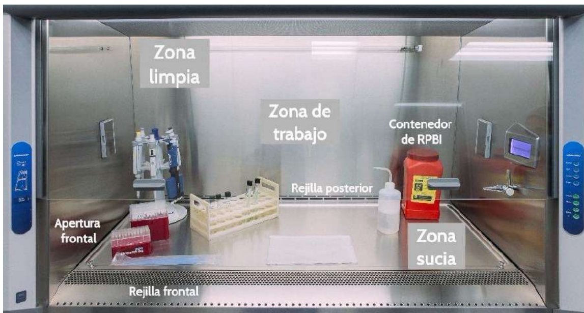
Figura 2. Cabina de Seguridad Biológica clase II tipo A2. Se muestra la distribución y acomodo recomendado de materiales en la cabina. A la izquierda se encuentra el área limpia donde se puede colocar las micropipetas y las gradillas de uso, así como las puntas para las micropipetas. Al centro se localiza la zona de trabajo, donde se dispone una capa absorbente sobre la superficie de trabajo y es ahí donde las muestras se inoculan. A la derecha se encuentra la zona sucia, donde se colocan los contenedores o bolsas de residuos peligrosos biológico infecciosos. Esta disposición puede invertirse para las personas zurdas. Fotografía: Marvin Eliu Garay.
