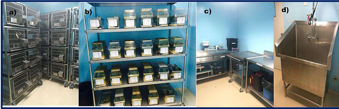
Figura 2. Cuartos para el mantenimiento de animales y de apoyo. En la imagen se muestra un cuarto para el mantenimiento de conejos con (a), un cuarto para el mantenimiento de ratones con cajas para el confinamiento primario de los animales (b), y dos áreas de apoyo: el cuarto de procedimientos generales (c), y el cuarto de lavado con una tarja para el lavado de las cajas y materiales (d).
