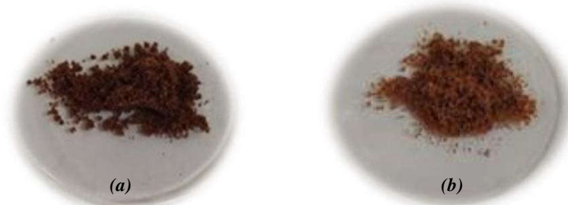
Figura 3.1 Aspecto de las pastas agotadas de aceite de nuez criolla (a); y Wichita-Western (b)
