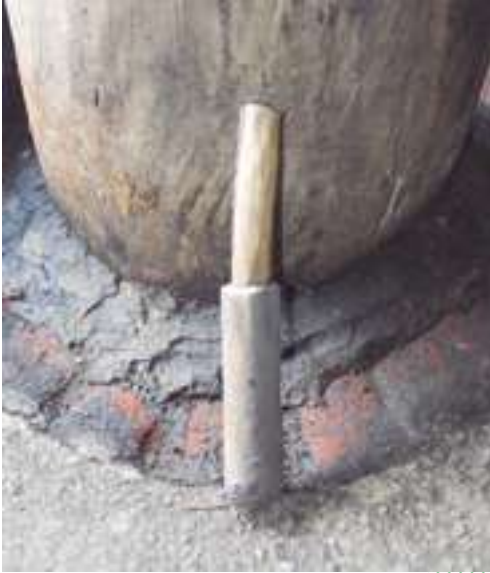
SELLADO CON BARRO, EN LA BASE DE CASCOMITE (ALAMBIQUE). MIACATLÁN, MORELOS
