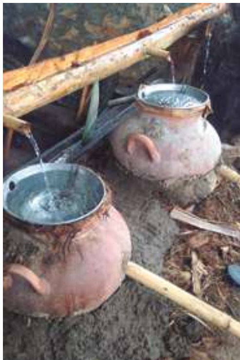
MEZCAL ANCESTRAL DESTILADO EN OLLAS DE BARRO
