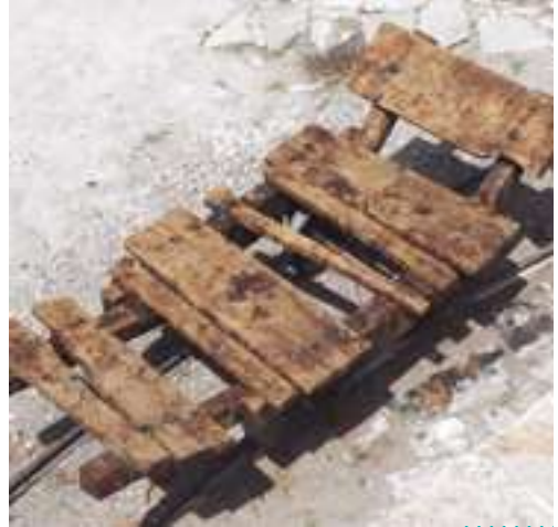
ARMÓN DE MADERA EMPLEADO PARA TRANSPORTAR EL AGAVE COCIDO HACIA EL ÁREA DE MOLIENDA. LAGUNA SECA, SAN LUIS POTOSÍ
