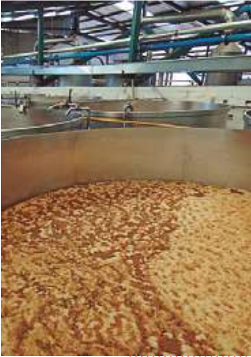
TINA DE ACERO INOXIDABLE CONTENIENDO MOSTO
