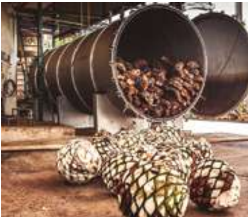
COCIMIENTO DE AGAVE EN AUTOCLAVE
