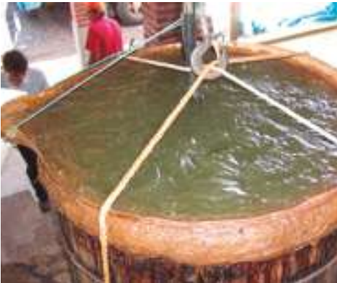
ENFRIADOR DE COBRE SOBRE MONTERA DE MADERA. MORELIA, MICHOACÁN
