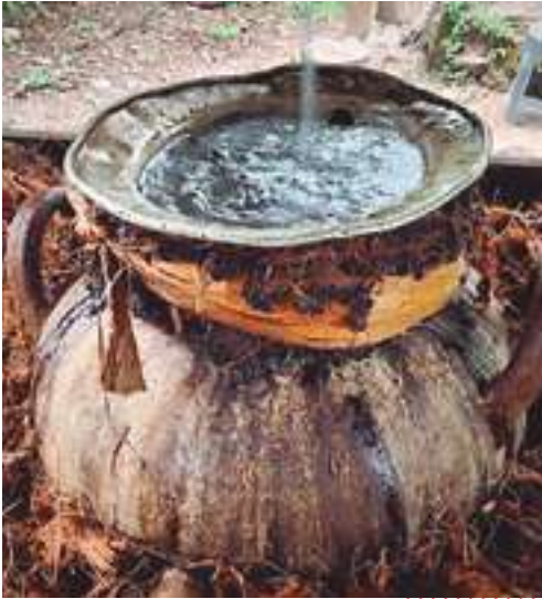
DESTILACIÓN EN OLLA DE BARRO. OAXACA
