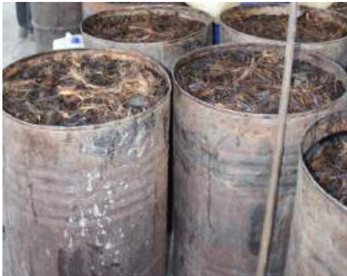
En algunas comunidades mezcaleras se utilizan los llamados Tambos metálicos en el proceso de fermentación.
