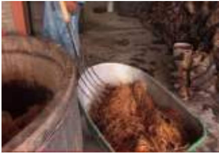
Uso de carretilla para cargar con agave triturado las tinas de fermentación.
