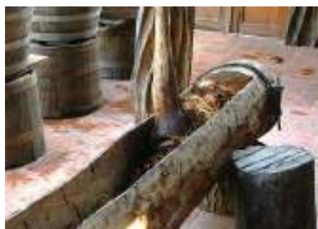
Batea de madera empleada en el Machacado de agave cocido.
