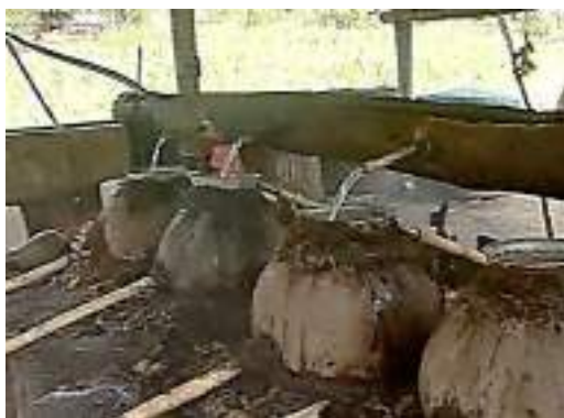
Destilación en olla de Barro (Oaxaca)
