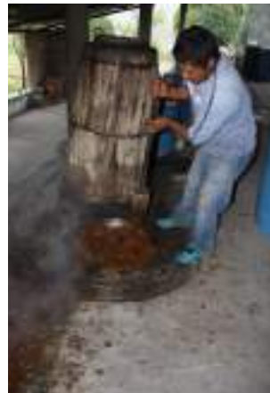
Uso del asentador para compactar el bagazo cocido y triturado en la olla de destilación. Zumpahuacán Estado de México.
