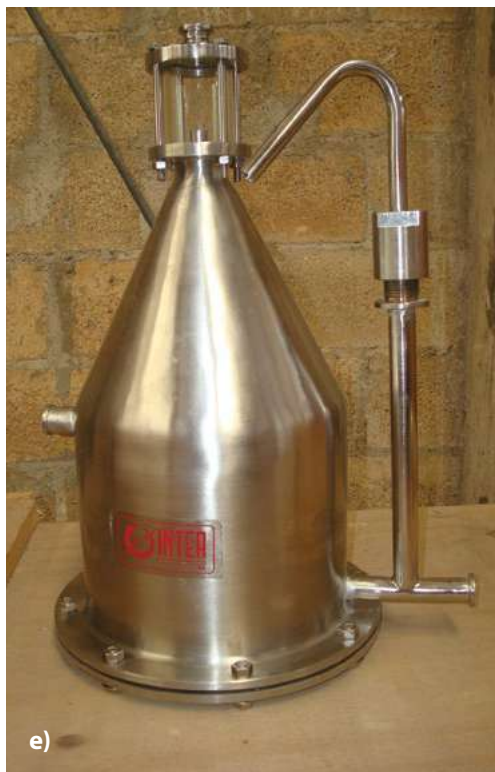
Figura 1. Equipos de la Planta Piloto de Alimentos: a) Despulpador, b) Lavadora de frutas, c) Precocedor helicoidal, d) Mesa taponadora, e) Tina de recolección de aceites ligeros
