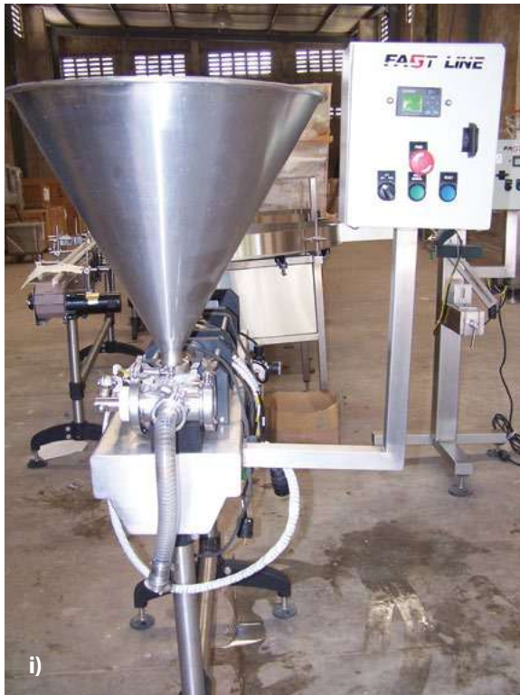
(Figura 1) Continuación... f) Tanque para mezclas, g) Secador de charolas, h) Tina de recolección de aceites pesados, i) Llenadora automática volumétrica, y j) Exhauster
