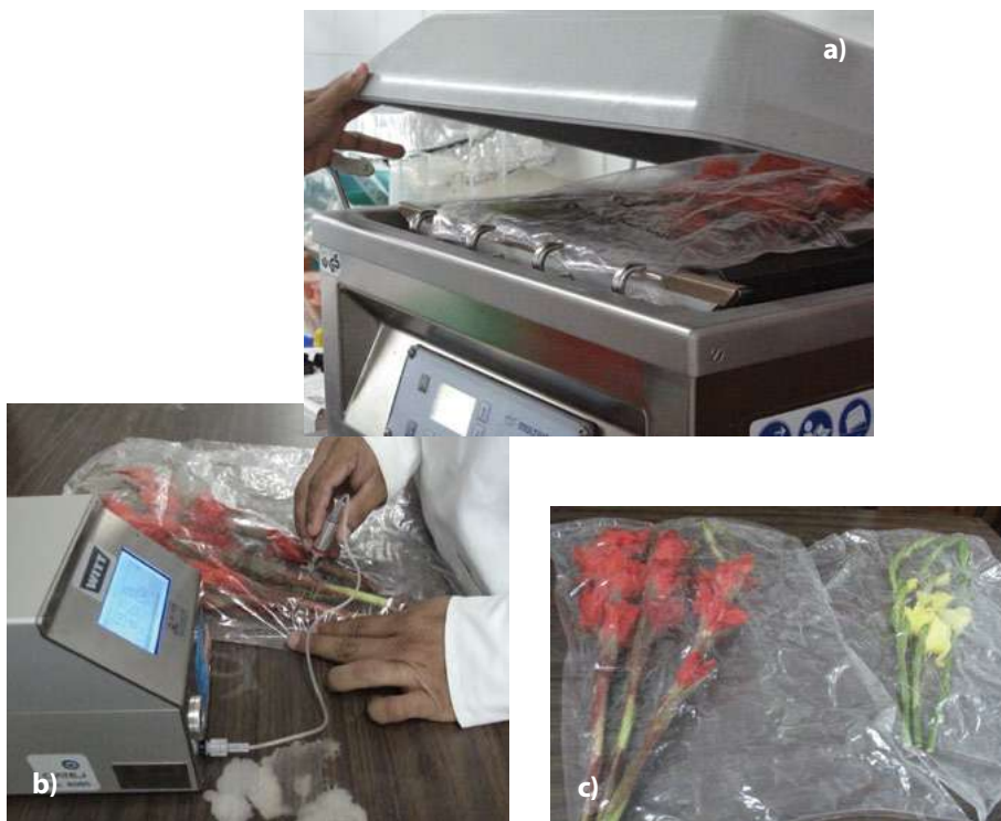
Figura 9. Aplicación de atmósfera modificada de empaque en nardo y gladiolo. (a) Inyección de gases en Campana Multivac C-200; (b) Análisis de gases en el interior del empaque; (c) Gladiolo en empaque con atmósfera modificada.
