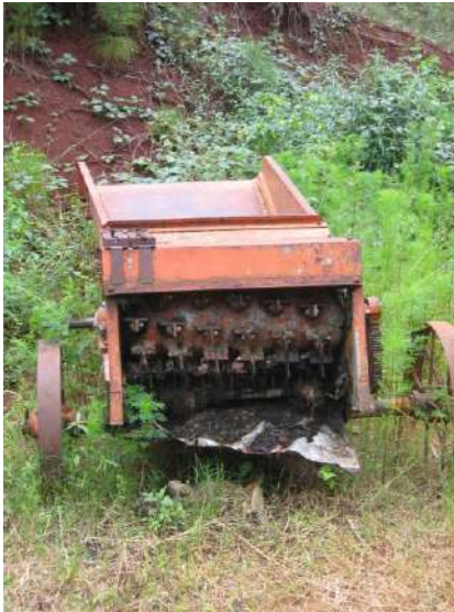
Figura 5: Implementos utilizados en el proceso de molienda para triturar las piñas cocidas de agave. A) Molino desfibrado. B) Batea o canoa rustica para machacado del agave cocido, elaborada con un tronco.
