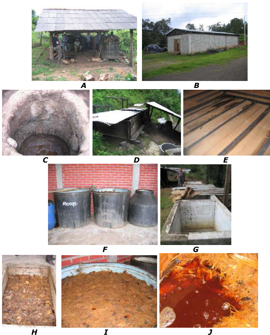
Lámina 12. Instalaciones de dos tipos de "vinatas". A) Instalación rústica debajo de un tejaban. B) Instalación más moderna en un edificio cerrado. Diferentes tipos de tinas de fermentación utilizadas en algunas "vinatas". C) Excavación en el piso. D) y E) Cajones de madera sellados con hule. F). Tinas de plástico. G) Tina de concreto recubierta de azulejo. Proceso de Fermentación. H) Cajón de madera enterrado en el piso. I) Aspecto de la superficie de la tina de fermentación sellado por el bagazo. J) Aspecto del mosto en proceso de fermentación.
