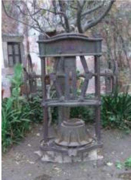
Figura 7. Prensa utilizada para exprimir el bagazo de agave cocido, el cual se lavaba después de pasar por el proceso de tritución en “*Tahona*”. Actualmente se localiza en uno de los jardines del patio interior de la hacienda “*Pozo Hondo*” como elemento de ornato (Fotografía: Juan Gallardo).
