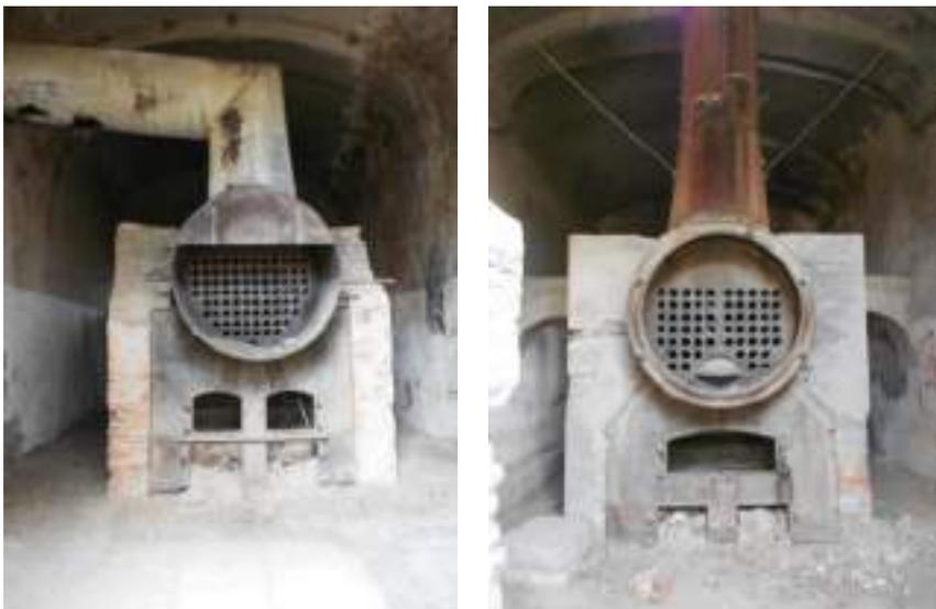
Figura 13. Las dos calderas con las que contaba la fábrica de mezcal “La Soledad”, las cuales se alimentaban con leña, el vapor generado se enviaba al área de destilación mediante tubería (Fotografías: Juan Gallardo).
