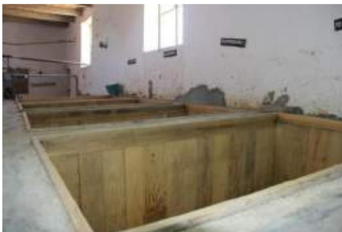
Figura 18. Tinas de mampostería recubiertas con duela de madera de roble empleadas en la fermentación, dentro de la fábrica de mezcal “San Francisco” (Fotografía: Juan Gallardo).
