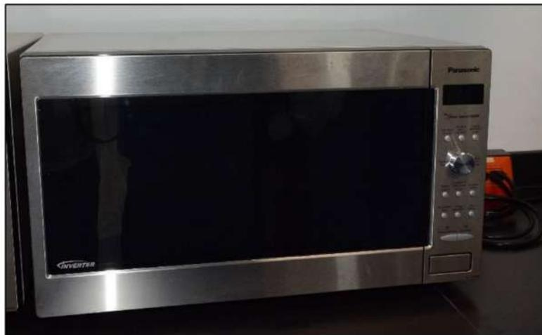
**Figura 6.** Horno de microondas utilizado para disolver sustancias congeladas o para licuar el agar adicionado al medio de cultivo. (Fotografía: Juvencio Castañeda).
