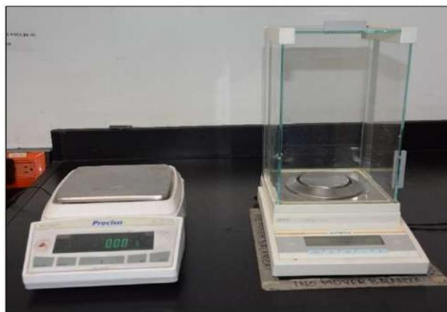
**Figura 4.** Balanzas. Izquierda: balanza granataria (Max. 1200g, Min. 0.5g). Derecha: balanza analítica (Max. 120g, Min. 0.0001g). (Fotografía: Juvencio Castañeda).
