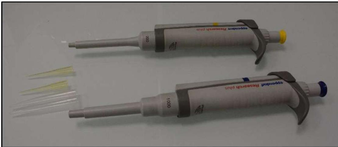
**Figura 7.** Micropipetas con puntas utilizadas para medir volúmenes en microlitros. (Fotografía: Juvencio Castañeda).
