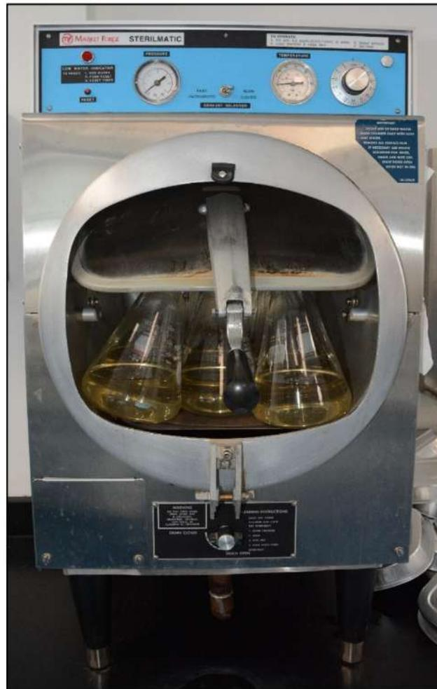
**Figura 8.** Autoclave semiautomática para esterilizar material mediante calor húmedo. (Fotografía: Juvencio Castañeda).
