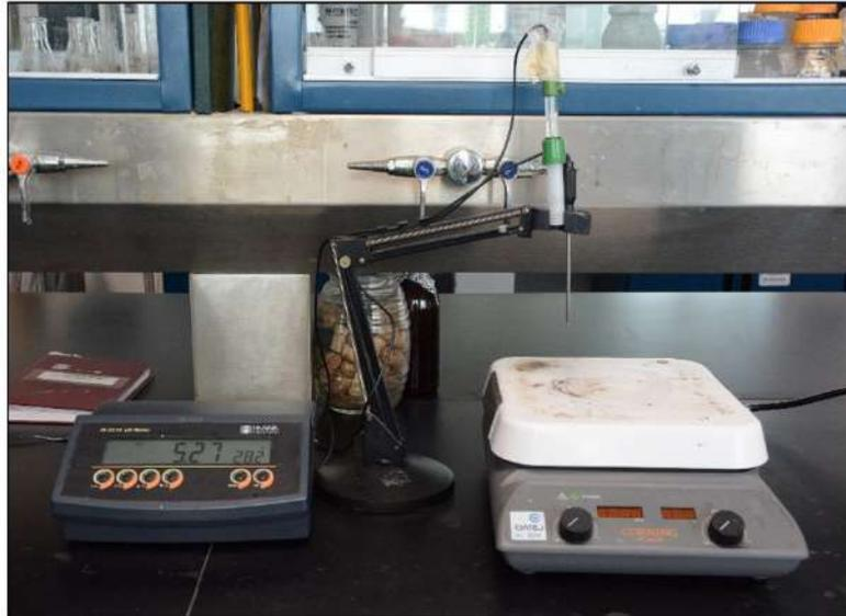
**Figura 5.** Potenciómetro (izquierda) y agitador magnético (derecha) para medir el pH y para disolver los compuestos del medio de cultivo respectivamente. (Fotografía: Juvencio Castañeda).
