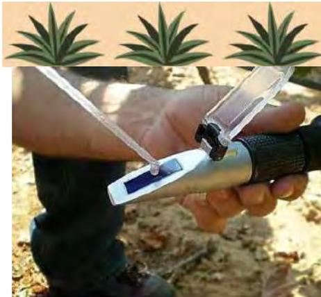
Brixómetro o Refractómetro
