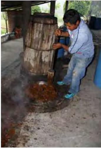
Uso del asentador para compactar el bagazo en la olla de destilación. (Zumpahuacán, Estado de México)
