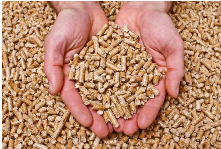
Figura 2. Pellets con longitud típica entre 5 y 40 mm (depositphotos.com, 2021).
