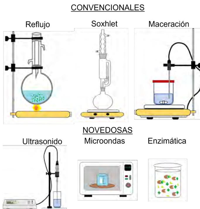
Figura 3. Sistemas y equipos convencionales y novedosos utilizados en la extracción de compuestos bioactivos como los compuestos fenólicos.
