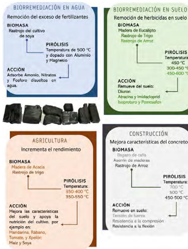
Figura 4. Ejemplos del uso del biocarbón como biomaterial aplicado en área de conservación ambiental, producción de alimentos y construcción.
