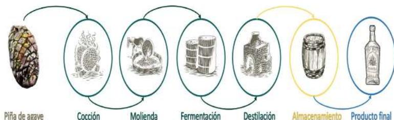
**Figura 1.** Esquema general del proceso de producción del tequila
