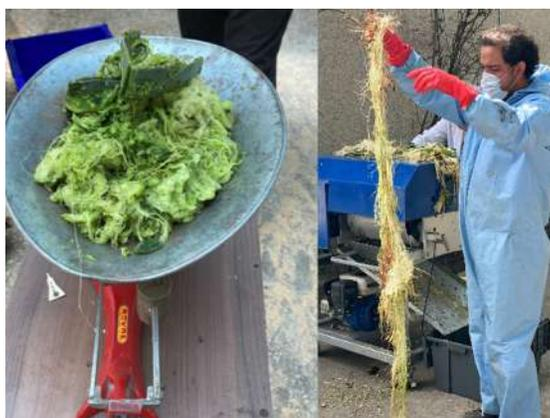
**Figura 5.** Pulpa (izquierda) y fibra (derecha) obtenidas por el raspado mecánico de las hojas de *A. salmiana* (Cortesía de F. Cortés-Bárceñas, febrero 2021)
