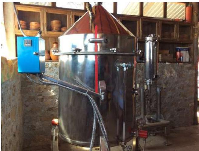
**Figura 2.** Alambique de acero inoxidable en el Rancho Los Sauces, Altzayacan, Tlaxcala, para destilar aguardiente del pulque (Cortesía de Eric Ortega Sánchez y J. Ro Sáinz)
