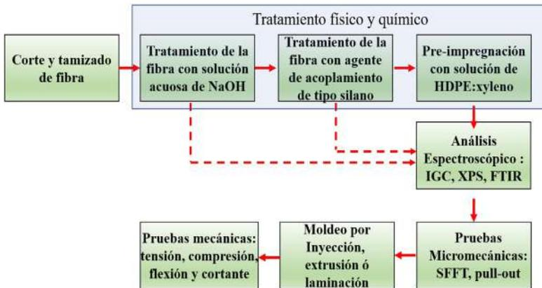
**Figura 2.** Esquema propuesto para modificación, caracterización de las fibras de henequén, fabricación del material compuesto y procedimientos de caracterización físico-química y mecánica del material compuesto
