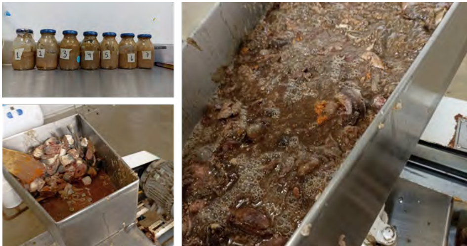
Figura 9. Procesamiento de residuos y obtención de ensilados proteicos Fuente: elaboración propia.
