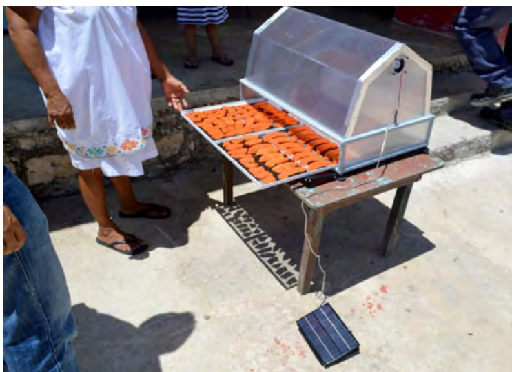
Figura 12. Puesta en marcha del secador solar tipo invernadero. Fuente: elaboración propia.
