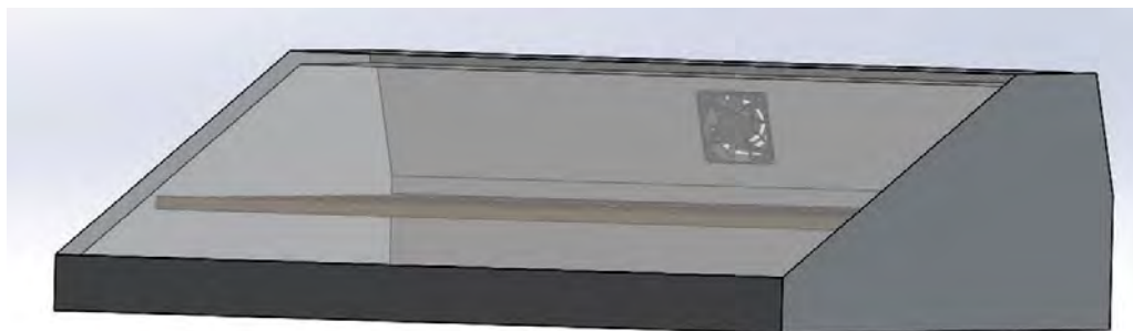
Figura 13. Secador solar tipo gabinete. Fuente: elaboración propia.
