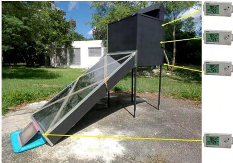
Figura 8. Secador solar indirecto tipo chimenea. Fuente: elaboración propia.
