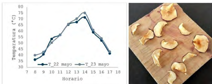
Figura 16. a) Comportamiento de la temperatura al interior del secador solar (22 y 23 mayo 2024). b) Manzana deshidratada. Fuente: elaboración propia.
