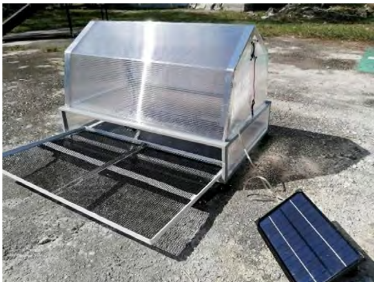
Figura 11. Secador solar tipo invernadero con ventilación forzada accionada con energía fotovoltaica. Fuente: elaboración propia.
