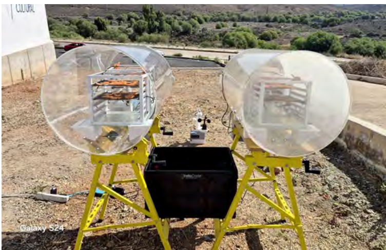
Figura 3. Secador solar cilíndrico tipo directo. Fuente: elaboración propia.
