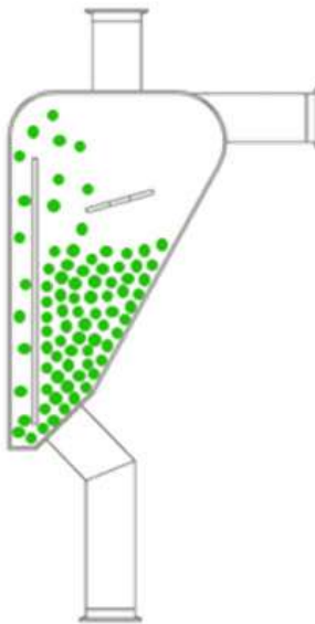
Figura 1. Lecho fuente desarrollado por Arriola-Guevara, 1997 y Arriola-Guevara et al., 2011). Patente No. 298223
