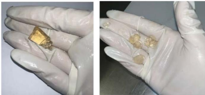
**Figura 3.** Primeras formulaciones de óvulos, en donde se puede observar la desintegración solo con la manipulación
